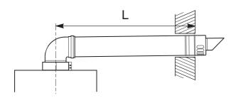
NOTE: THE FLUE MUST BE INCLINED TO THE BOILER 6 720 610 602 - 13.10
